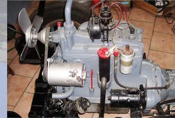
Aufarbeitung von Motor und Getriebe.
