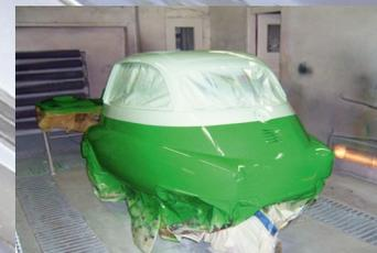
Teil- und Komplettsanierung von Karosserien: von der Endlackung bis zum neuen Lackaufbau mit Hohlraumkonservierung.
